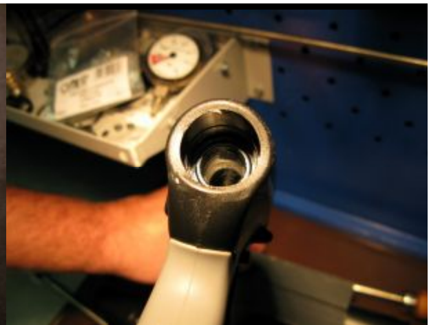
Положение торца ствола в рукояти. Пазы вошли в выступы.
