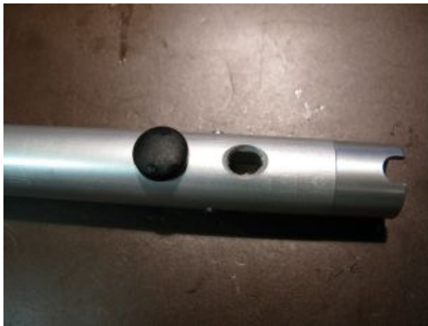
Положение ствола перед установкой. Пазы расположены вертикально.
