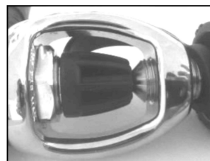
Винт соединения Уоке закручен не полностью
